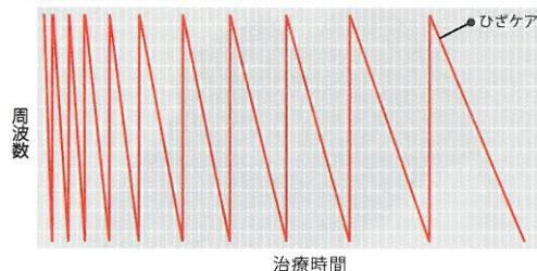
ひざ治療のメカニズムは複雑で、種々の周波数が関係していると言われています。スイープ変調波電流は作用効果を高めるために治療電流周波数4000Hzの波形をAM変調し、それを50~1000Hzの間で自動可変(スイープ)したスイープ変調波で、幅広い痛みへの対応とより深い部分への治療効果を充実させる当社独自のテクノロジーです。
